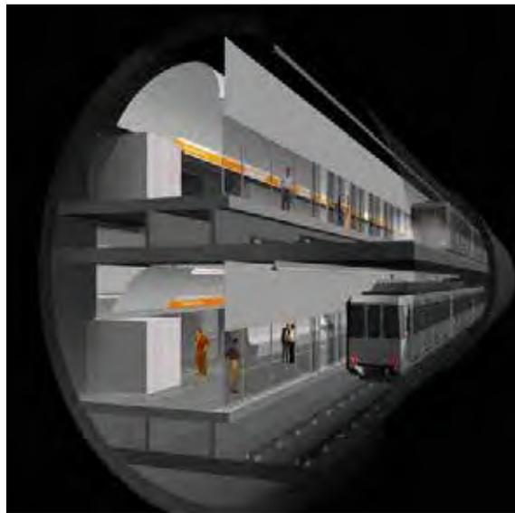
Figure 2 : Tunnel au bouclier, type Barcelone.
