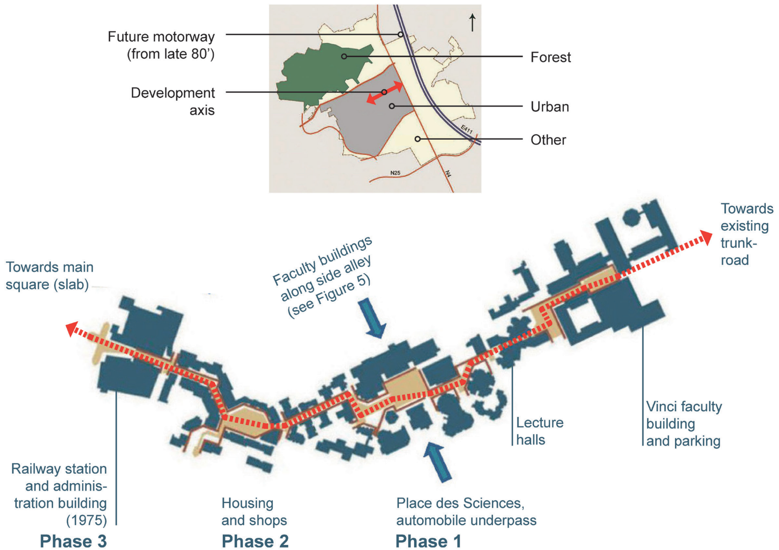
Illustration 4 : Schéma conceptuel de plan linéaire UA pour l'axe central, à partir de la RN 4, et son application à l'axe (600 m) Place du Levant-Place de l'Université. © André Mertens.
